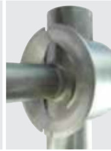
Uchytávacie čeluste pre T-kusy s možnosťou uchytania hrdla a konca zváranej trubky
